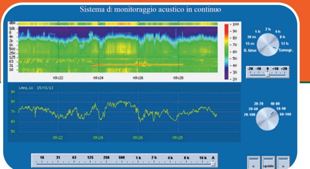
I sistemi di monitoraggio live sono costituiti da fonometri integratori di classe 1 che forniscono l'analisi del segnale in tempo reale in 1:3 di ottava con spettri a cadenza di uno short L<sub>Aeq</sub>1s; il tutto è interfacciato attraverso un modem ad un server web. Il fonometro non registra alcun dato ma invia in tempo reale ciò che acquisisce ad un server remoto e lo rende disponibile sulla rete internet.
